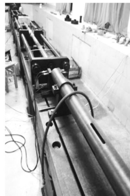
图2 SHPB冲击试验装置 Fig. 2 SHPB impulse device
