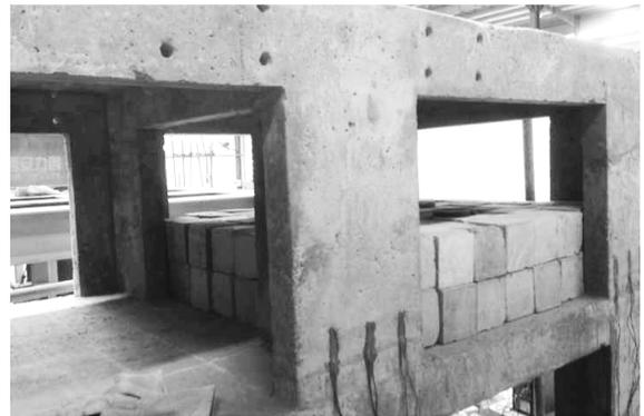
图 6 第二层楼面加载示意图
