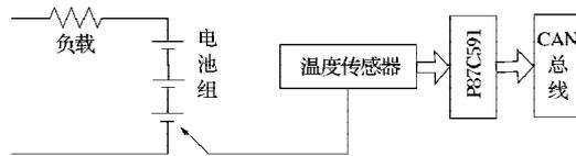
图5 温度采集模块基本结构图
