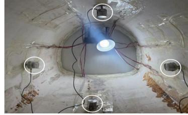
图 5 加速度传感器布置示意图
