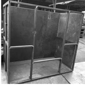
图8 室内模型试验模型箱
