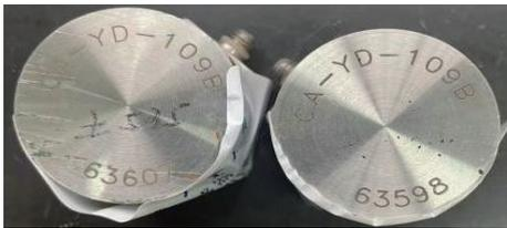
图10 压电式加速度传感器
