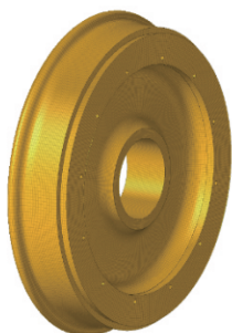
图5 刚性车轮网格划分
