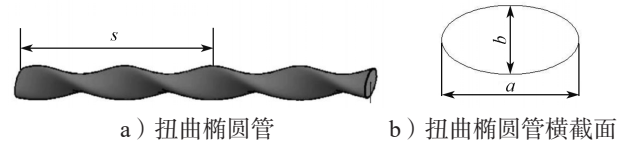
图 10 扭曲椭圆管结构示意图 Fig. 10 Structure diagram of twisted oval tube
