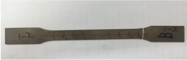
图2 Nb-Ti-Al 基低密度铌合金拉伸试样图
