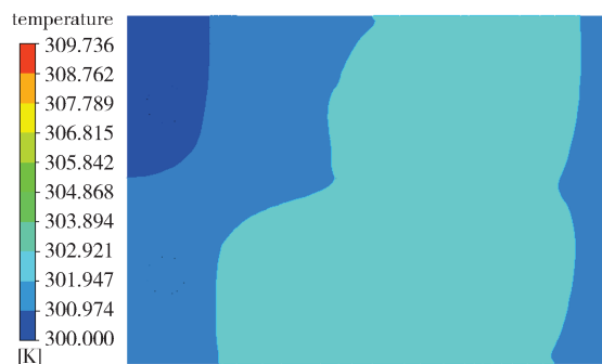
图 9 液冷板温度分布云图
