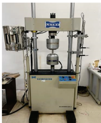
图2 PLD-100型微机控制电液伺服高温疲劳试验机
