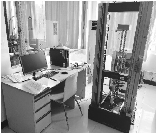
图 6 三维力加载实验测量系统
