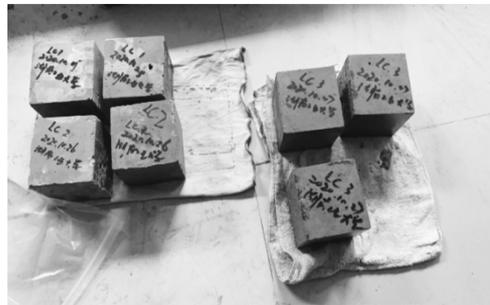
图 2 轻骨料混凝土试块
