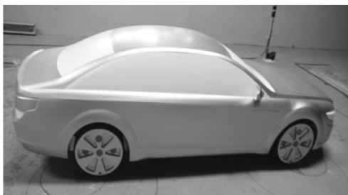
图 7 轿车的风洞实验模型
