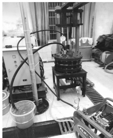
图2 淹没空化射流冲蚀实验现场图
