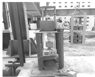
图 1 剪切试验装置
