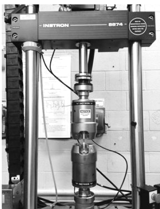
图2 静态拉伸试验
