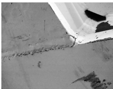
图1 A型架焊缝开裂
