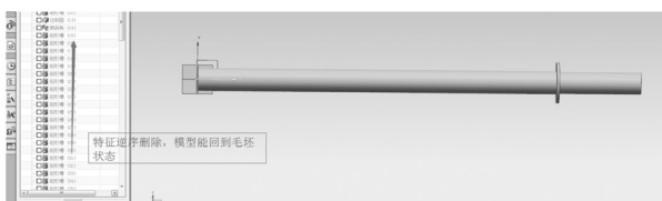
图 6 逆序抑制特征, 模型能够回到毛坯状态, 无报错现象
