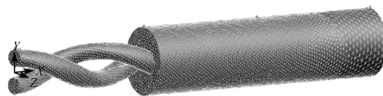
图2 旋流式壅塞空化器的网格模型
