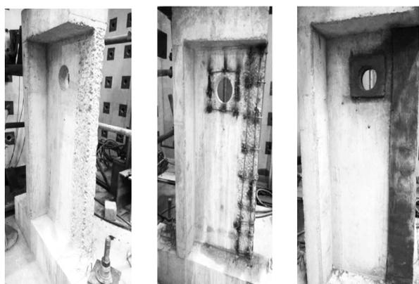
a) 凿毛      b) 焊接钢筋网      c) 涂抹复合砂浆
