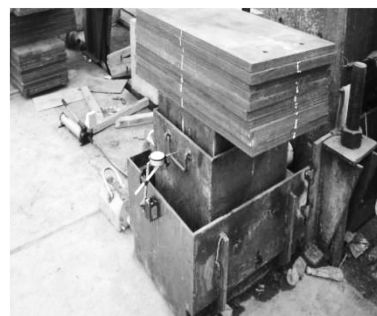
图9 自制大型水平剪切试验仪
