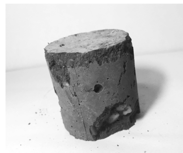
a) 冲击加载损伤后的试件
