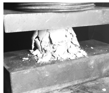
b) 28 d 静载破坏后的试件
