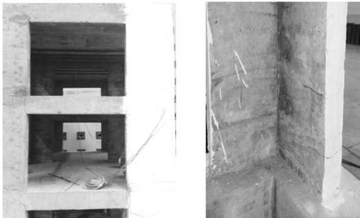
b) ①号轴线梁端裂缝 c) ①号轴线墙肢底部裂缝
