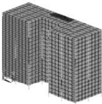
图2 框筒结构的整体模型
