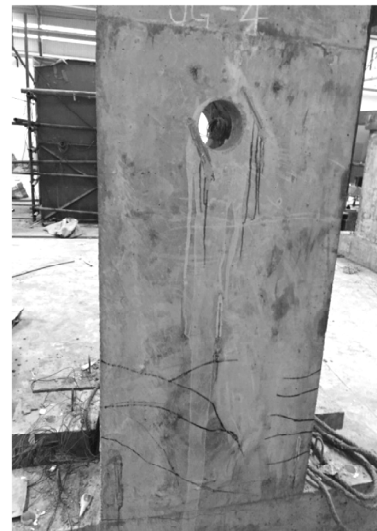
图5 LKD120 最终破坏形态
