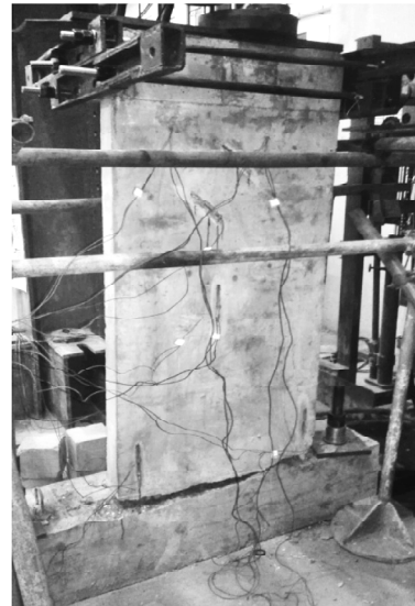
图4 LKD000 最终破坏形态
