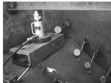
图3 模型试验加载装置和测试设备
