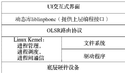
图4 语音调度系统终端平台软件架构
