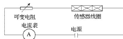
图11 测线圈阻抗电路图
