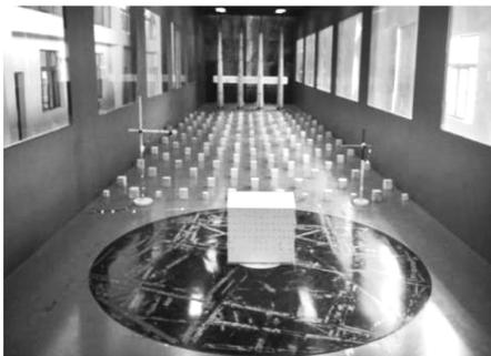
图2 风洞试验布置图
