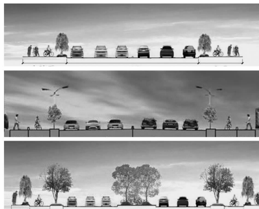
图2 两幅路、三幅路、四幅路横断面
