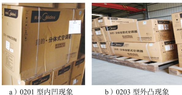
图 1 02 型纸箱在储运过程中的凹凸现象
