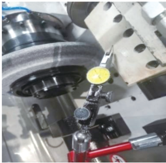
图 3 砂轮修整器刚度测试 Fig. 3 Experimental stiffness test
