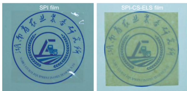
a) SPI 膜和 SPI-CS-ELS 复合膜的外观图
