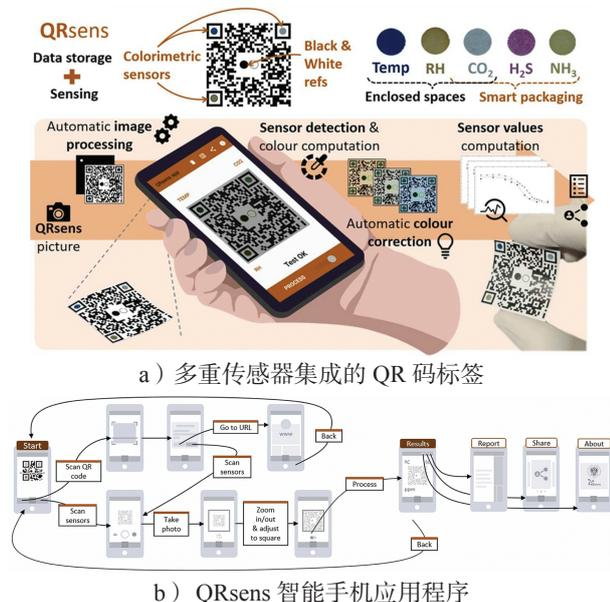
图 4 多重传感器集成的 QR 码标签及 QRsens 智能手机应用程序
