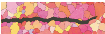
图 3 具有不同晶粒尺寸的三个典型 2524-T3 样品的疲劳裂纹扩展路径
