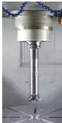
图 5 内置动力吸振器的减振铣刀
