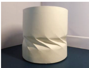
图7 对角折叠桶状变容积包装设计
