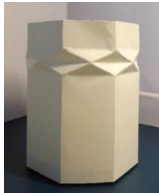
图 12 改进后的吉村式折叠桶状变容积包装
