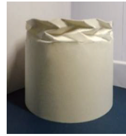
图 3 改进后的三浦折叠桶状变容积包装结构
