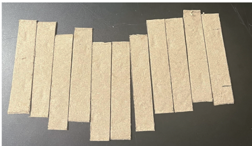
图1 纸浆模塑拉伸试样
