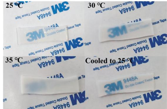
图 6 不同温度下透过 PNIPAM/Gelatin 水凝胶观察图案的示意图
