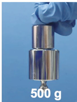
图 13 p(\text{AA-AMPS-HEMA}) 水凝胶黏附 500 g 的砝码
