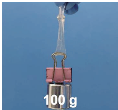
图 4 p(AA-AMPS-HEMA) 水凝胶提起 100 g 砝码示意图 Fig. 4 p(AA-AMPS-HEMA) hydrogel lifting
