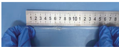
图 5 p(AA-AMPS-HEMA) 水凝胶扭曲及打结拉伸图
