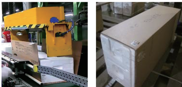
a) 自动化折叠过程 b) 桶型纸箱成型图
