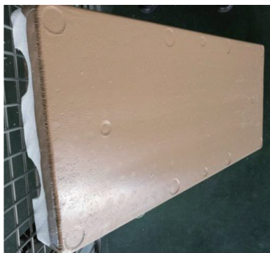
图 1 泡沫覆膜缓冲结构
