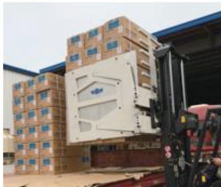
图7 夹抱车上下卸货
