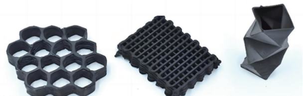
图 14 陶瓷材料 3D 打印大尺寸氮化硅
