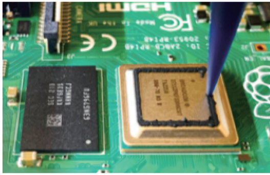
图 11 在 CPU 芯片上直接印刷散热片
