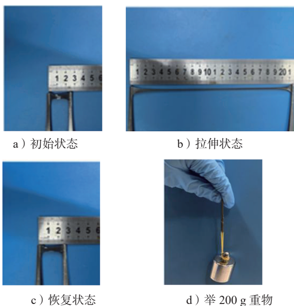
图 2 LM/p(SBMA-co-HEAA) 导电水凝胶力学性能示意图
