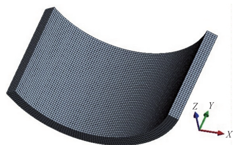
图 4 第 3 组试样网格划分图
