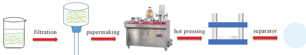
图1 造纸法制备隔膜示意图
