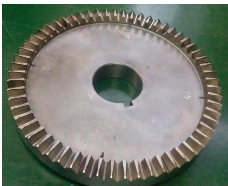
图 6 面齿轮材料 18Cr2Ni4WA 实物图
