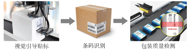
图 14 3C 电子产品包装工艺流程
