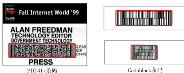
图 16 不同规格的条形码感兴趣区域提取效果
