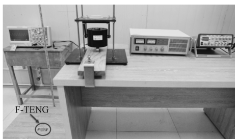
图5 离体振动测试平台
