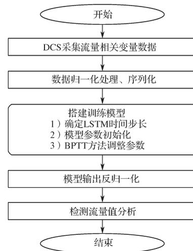
图 3 灌装流量检测模型的建模流程图
