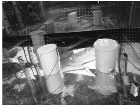
图 5 在恒温恒湿箱中测试 PLA 保温杯图
