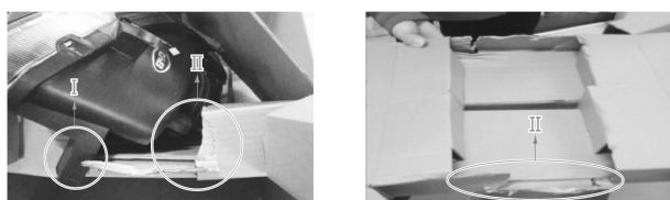
a) 放置大灯 b) 取出大灯 图 6 改进前内部缓冲件的跌落试验结果图
