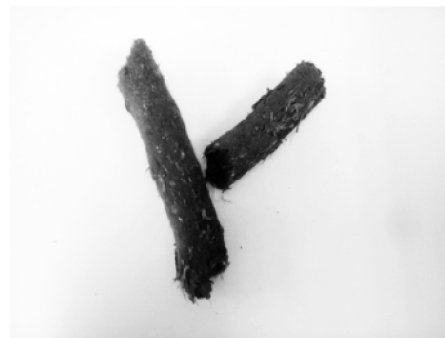
图 2 RDF 成品 Fig. 2 RDF samples
